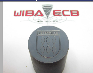
Pulvermetallurgischer Stahl mit nur einer Elektrode Toleranz 10 µm
